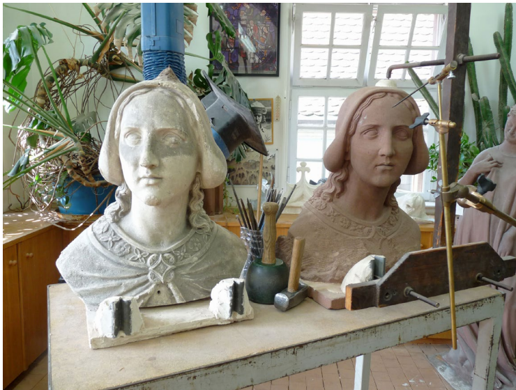
Steinmetz- und Bildhauerwerkzeug zum Übertragen von Punkten von einer Vorlage auf das Werkstück (Quelle: https://commons.wikimedia.org/wiki/File:Atelier_de_sculpture-Cath%C3%A9drale-Strasbourg.jpg )
