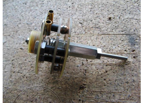
Do-It-Yourself-3D-Tastsensor (Quelle: http://www.machschildt.de/html/3d-taster.html )
