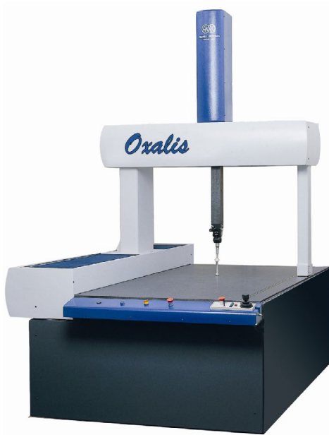
Haptisches CNC-Messsystem für die industrielle Anwendung (Quelle: https://it.m.wikipedia.org/wiki/Macchina_di_misura_a_coordinate )
