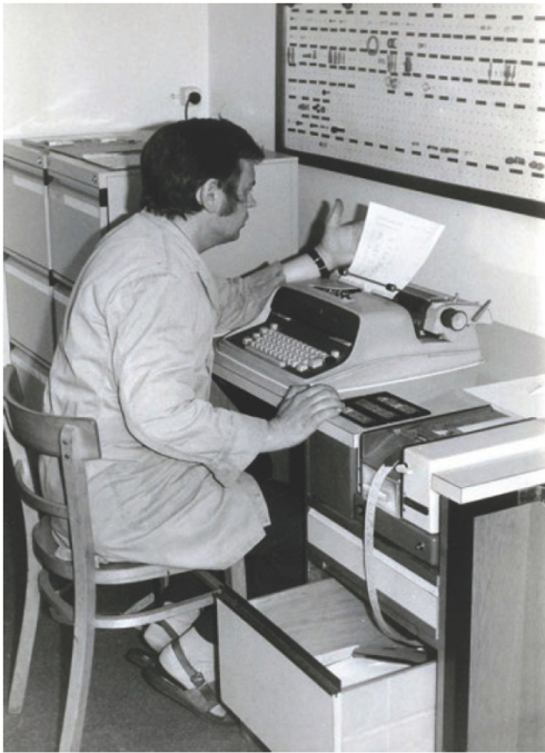
Bild 1.3 Das Programmieren eines Lochstreifens einer NC-Maschine
