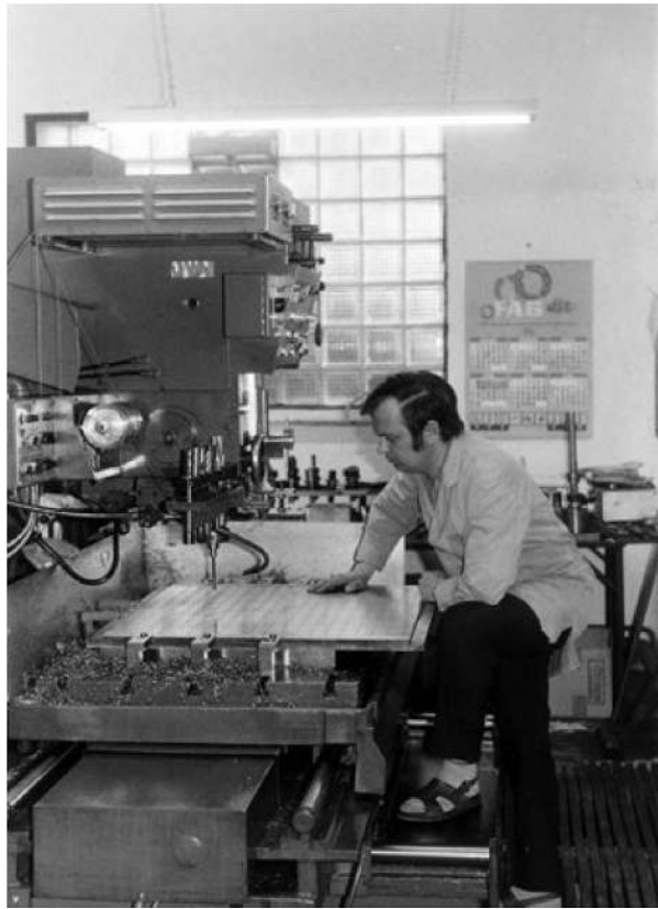
Bild 1.5 Das NC-Programm, hier ein Bohrbild, wird automatisch abgearbeitet
