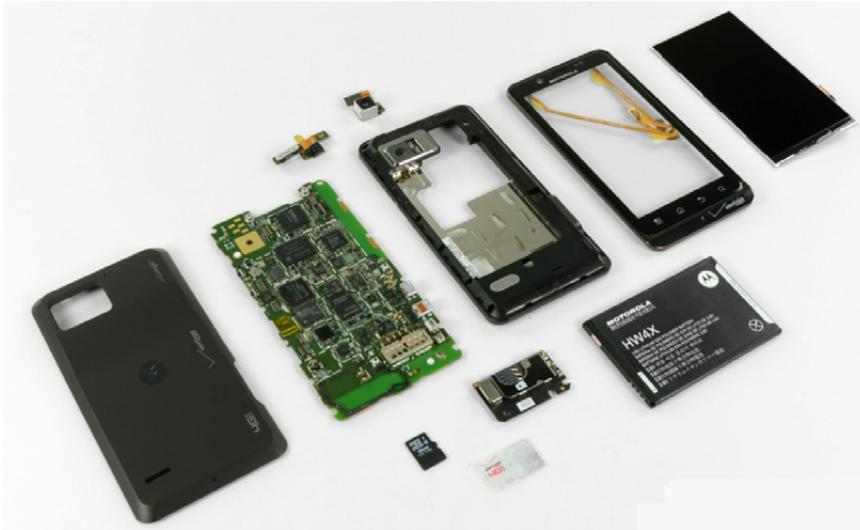
Abb. 1–2 Komponenten eines Smartphones
