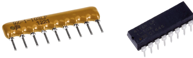
Abb. 2.3: Widerstandsnetzwerke gibt es in SIL- (links) und DIL- (rechts) Gehäusen
