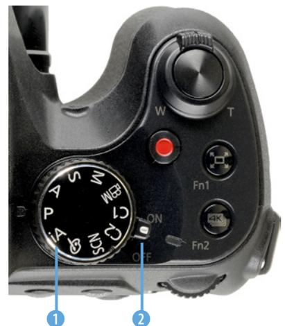
▲ Dies sind der ON/OFF-Schalter und das Moduswahlrad.
