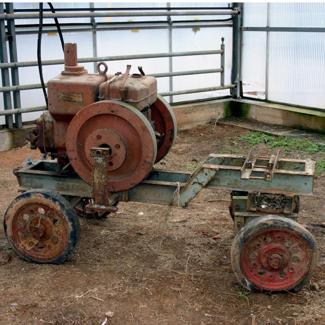
Ein ab 1928 gebauter Stationärmotor Typ GW 20, montiert auf ein selbstgebautes Fahrgestell.
