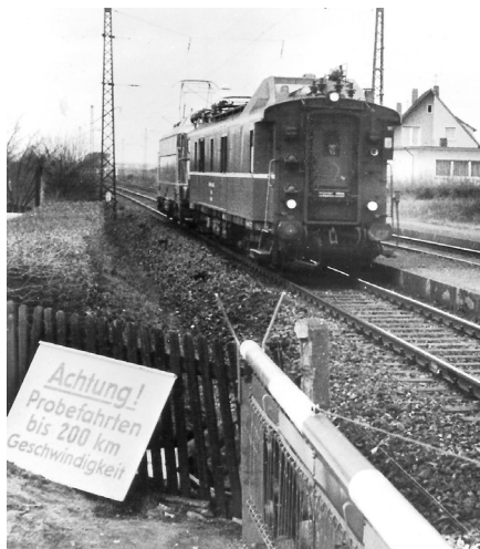
Als 1963 Probezüge mit bis zu 200 km/h Geschwindigkeit gefahren wurden, mussten zwischen Bamberg und Forchheim alle Schranken geschlossen sein, ehe der Zug abfahren durfte. Foto: Slg. DB-Museum Nürnberg
