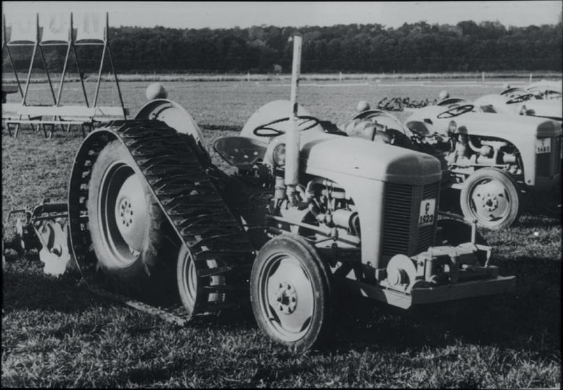
*Dieselschlepper TEF-20 mit Raupenfahwerk.*
