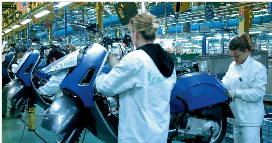
Fließband: Verlegung der Elektrokabel an einer Granturismo.
