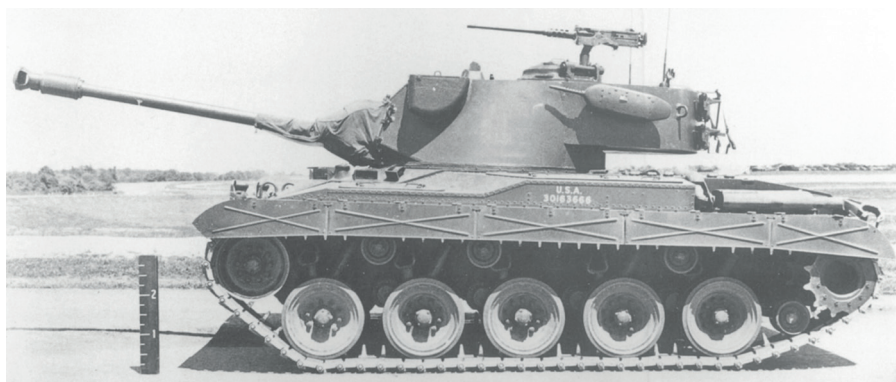
T37 auf dem Aberdeen Proving Ground (APG), Maryland, USA, 3. Juni, 1949. Man beachte die MG-Behälter an den hinteren, sowie die Ausblicke des Entfernungsmessers (EM) an den vorderen Turmseiten. (NARA)
