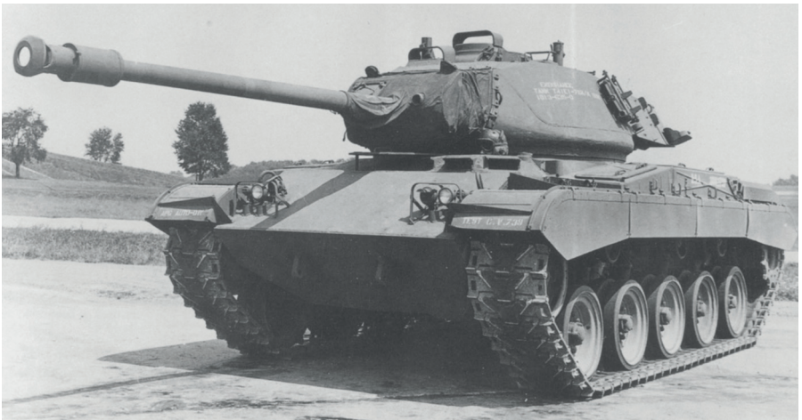
Ein früher T41E1 während seiner Erprobung auf dem APG. Man beachte die Turmkonstruktion, die sich von späteren Fahrzeugen unterscheidet, insbesondere die Schweißnaht an der Seitenwand, sowie die später nicht mehr montierten Kettenblenden (NARA)
