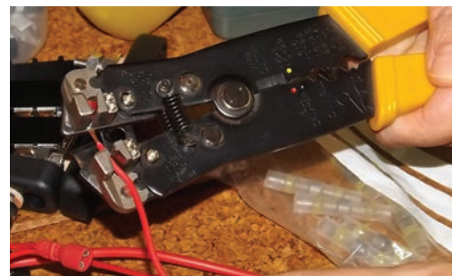
Nach dem Abschneiden des Kabels wird das Ende mit einer automatischen Abisolierzange von der Plastikummantelung befreit, ohne den Leiter zu beschädigen.
