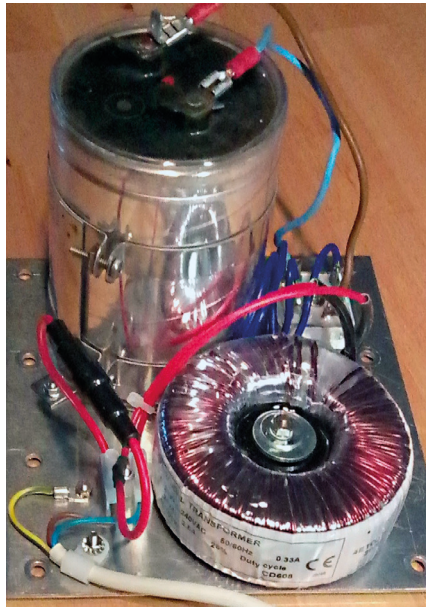
Bild 1.7: Das unregulierte Netzteil nach Bild 1.6 auf einer Metallplatte aufgebaut.
