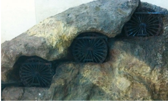
Abbildung 6: Anordnung von Förderrädern zur Entwässerung im Bergbau im 2. Jhdt., Modell Museo De Huelva, Andalusien
