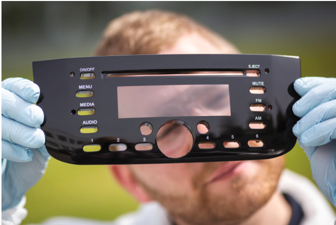
Bild 1.2 Individuelle Beschriftung und eingebettete Sensorik verleiht Frontblenden aus Kunststoff neue Gebrauchseigenschaften (Quelle: Kunststofftechnisches Institut an der TU Ilmenau)
