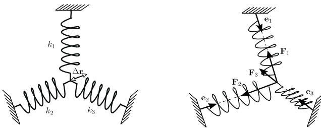
Bild 1.2 Steifigkeitstensor eines Federsystems
