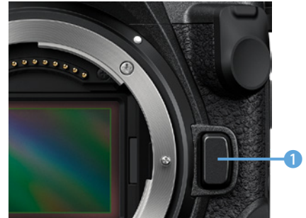
▲ Drücken Sie zum Wechseln des Objektivs die Objektiventriegelungstaste.
