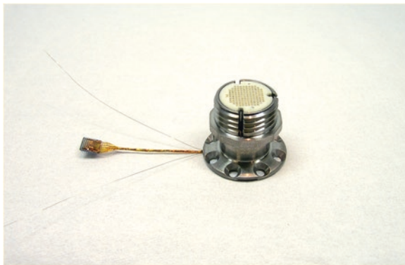
Abb. 1.4 Utah-Array verbunden mit einem transdermalen Sockel. (Mit freundlicher Genehmigung von Blackrock Microsystems LLC)
