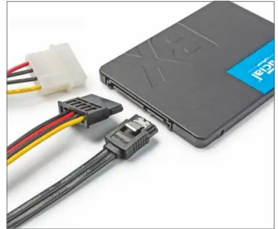
**Die Systemvoraussetzung für eine SATA-SSD sind in praktisch jedem Rechner der letzten zehn Jahre erfüllt: Ein SATA-Anschluss auf dem Mainboard, ein SATA-Datenkabel und einen Stromanschluss vom Netzteil. Sind nur veraltete Molex-Anschlüsse (oben links) frei, tut es auch ein Adapter.**
