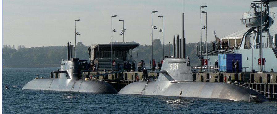
Die U-Boote der Klasse 212A, im Bild U 31 (re) und U 32 (li), sind weltweit die modernsten konventionellen U-Boote. Sie sind mit einer Brennstoffzelle ausgerüstet. Foto: Autor
