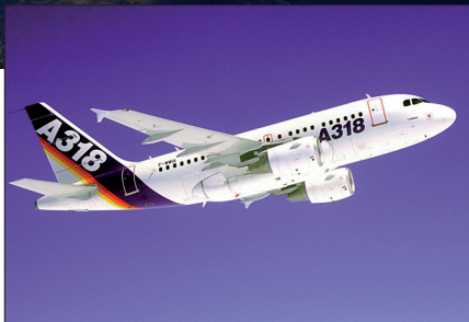
Prototyp der A318 mit der Kennung F-WWIA. Die Maschine war mit CFM-56-5-Triebwerken ausgerüstet.
