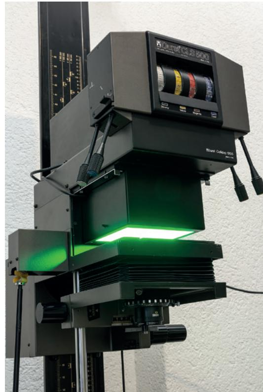
Abbildung 1.7: Vergrößerer mit eingebauter Heiland-LED-Lichtquelle
