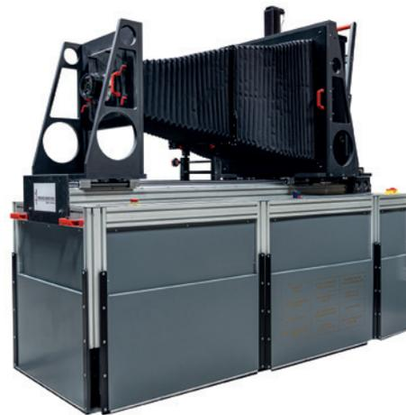
Abbildung 1.8: Mamont-Horizontalvergrößerer von Heiland electronic
