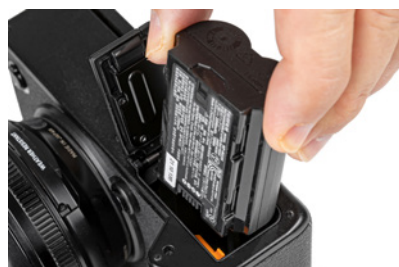
▲ Einlegen des Akkus vom Typ NP-W235 (7,2 V, 2200 mAh, 16 Wh).
