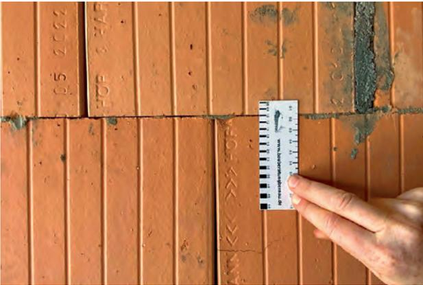
Einsatz eines Rissbreitenvergleichsmaßstabs zur Dokumentation der Fugenbreite – ein äußerst nützliches Hilfsmittel
