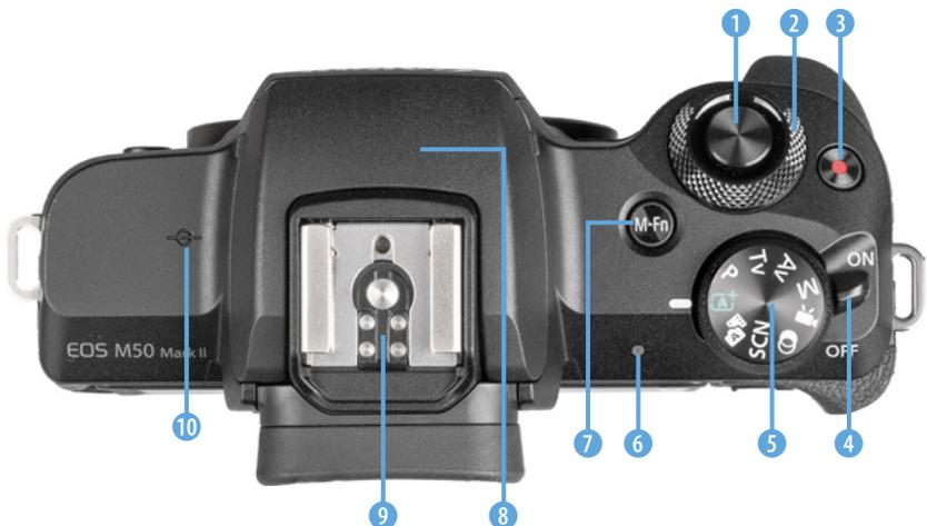
Die **M-Fn-Taste** (Multifunktionstaste) 7 ist standardmäßig mit der ISO-Wert-Einstellung belegt, kann aber auch mit einer Reihe anderer sinnvoller Funktionen verknüpft werden (siehe ab Seite 257).
