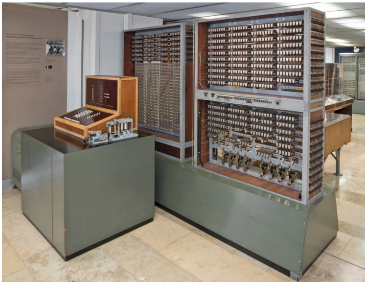
Bild 1.8 Elektromechanische Rechenmaschine (Zuse Z3), entwickelt von Konrad Zuse 1941 in Berlin (© Archiv Deutsches Museum, München, 2016) http://www.deutsches-museum.de/archiv
