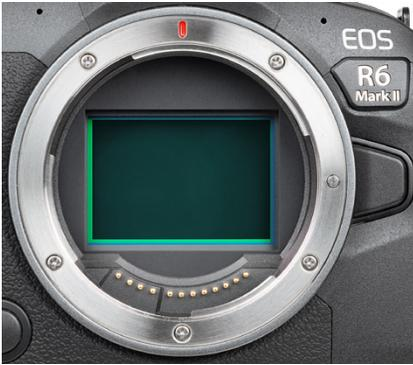
▲ Blick auf den CMOS-Sensor bei eingeschalteter EOS R6 Mark II. Das RF-Bajonett hat 12 Kontakte für die Kommunikation zwischen Objektiv und Gehäuse.
