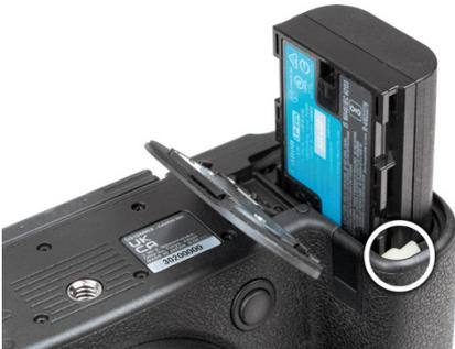
▲ Verriegelung zur Seite schieben und Akku mit den Kontakten nach unten einlegen.
