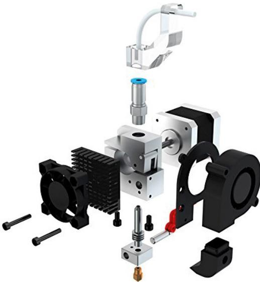
**Bild 2.5** Explosionsdarstellung eines Extruders mit Hotend (Druckermodell: BQ)
