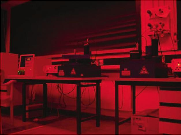
▣ **Abb. 1.18** Lumineszenz-Messgeräte im Datierungslabor des LIAG in Hannover. Das Arbeiten erfolgt unter Rotlicht, um Belichtungen der Proben zu vermeiden. (Quelle: M. Frechen)
