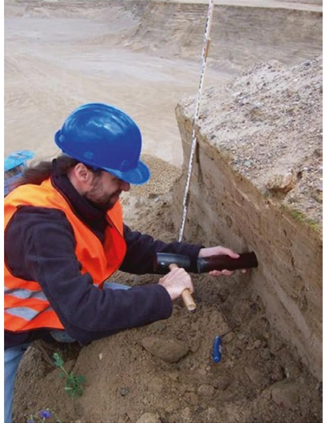
▣ **Abb. 1.19** Probenahme für die OSL-Datierung. Die Probe wird mittels einer lichtdichten Röhre aus der Aufschlusswand entnommen, da jeder Lichteinfall auf die Probe vermieden werden muss. Die Proben werden erst im „Dunkellabor“ bei Rotlicht aus der Röhre entnommen. (Foto: Wenske)
