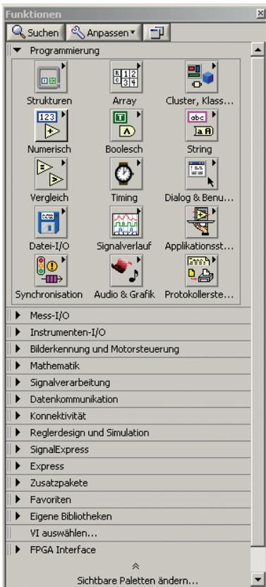
**Bild 1.8** Palette mit Funktionen, mit deren Hilfe das Programm im Diagramm erstellt wird. Hier ist die Teilpalette 'Funktionen' – 'Programmierung' geöffnet. Die Voreinstellung bei Version 2014 ist wieder 'Express'. Die letzte Zeile wird nur angezeigt, wenn man vorher das Zusatzmodul 'FPGA Interface' mit installiert hat.
