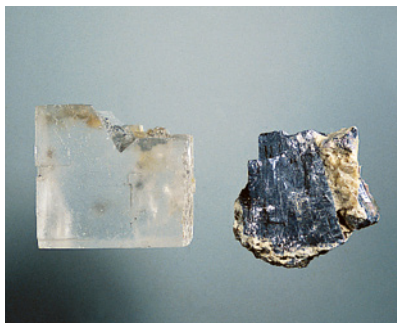
Steinsalz (links) zerfällt beim Spalten in lauter perfekte Würfel, genauso wie Bleiglanz (rechts).
