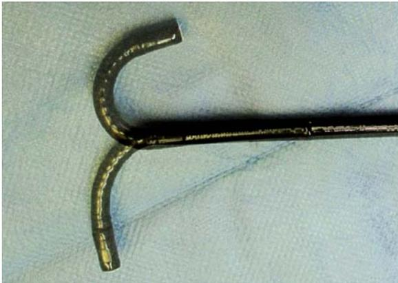
■ **Abb. 2.3.** Die Abwinklung durch die im Schaft enthaltenen Seilzüge ist maximal in Richtung der Gerätvorderseite (Hebelaktion nach unten)
