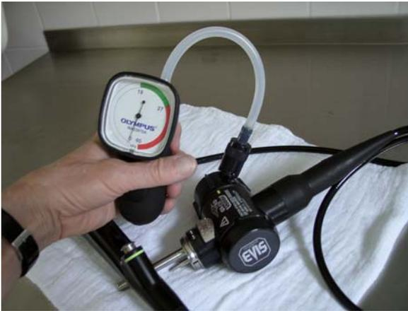
▣ **Abb. 2.6.** Verbindung des Schutzkappen-Stutzens mit einer manuellen Apparatur für die Dichtigkeitstestung. Bei der automatischen Aufbereitung versieht die über diesen Zugang verbundene Waschmaschine den Test und unterbricht das Programm, wenn ein Druckabfall zu registrieren ist
