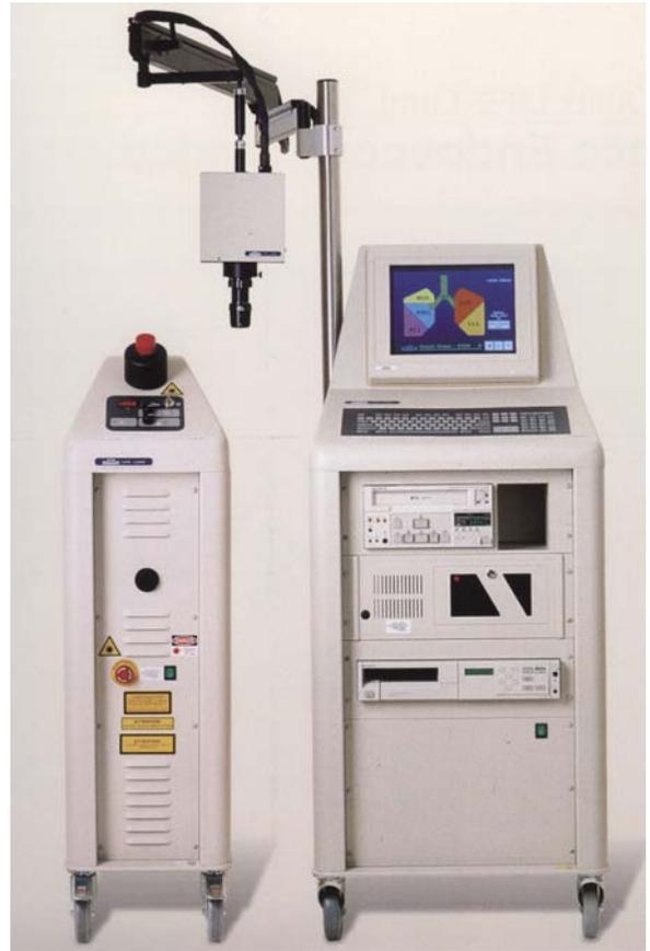
Abb. 2.11. Das erste weltweit eingesetzte Autofluoreszenzsystem LIFE-Lung von Xillix, Vancouver, bestehend aus der Laserlichtquelle, der Prozessorkonsole und der ausschwenkbaren CCD-Kamera
