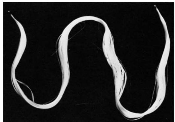
Abb. 1.8. Eines der ersten Glasfaserbündel der Firma Machida. Die kohärent angeordneten Fasern wurden an einer Stelle verkettet, getrennt und die freien Enden poliert
