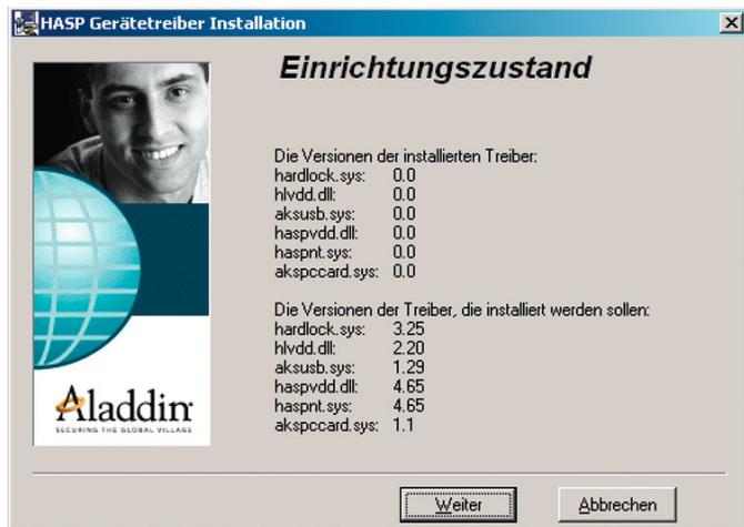
Abb. 2.4. Installation des Dongle-Treibers
