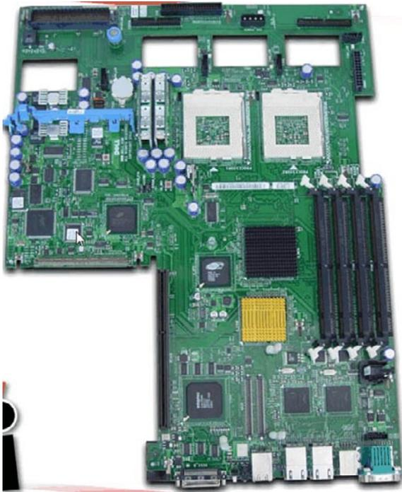
**Abbildung 1.5:** Dual-Sockel-Mainboard
