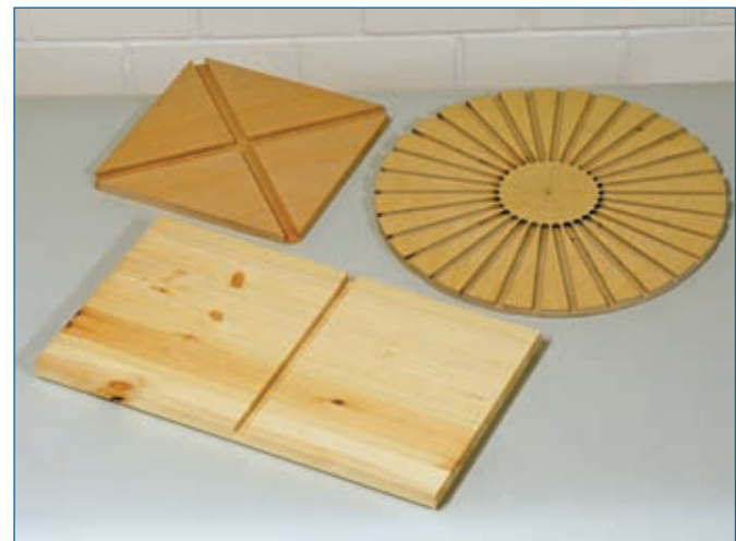
Abb. 4.1.7: Mit einer Führungsschiene kann man nicht nur präzise bei großem Abstand zur Werkstückkante, sondern, wie bei diesen Werkstücken, auch diagonal oder z. B. in runde Werkstücke fräsen. Quelle [3]
