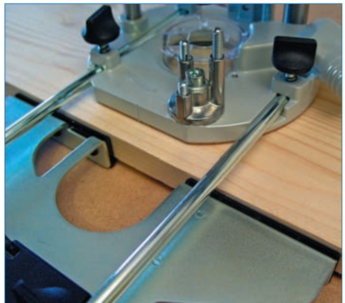
Abb. 4.1.2: Mit einem Parallelanschlag kann man in einem selbst gewählten Abstand zur Werkstückkante exakt fräsen.
