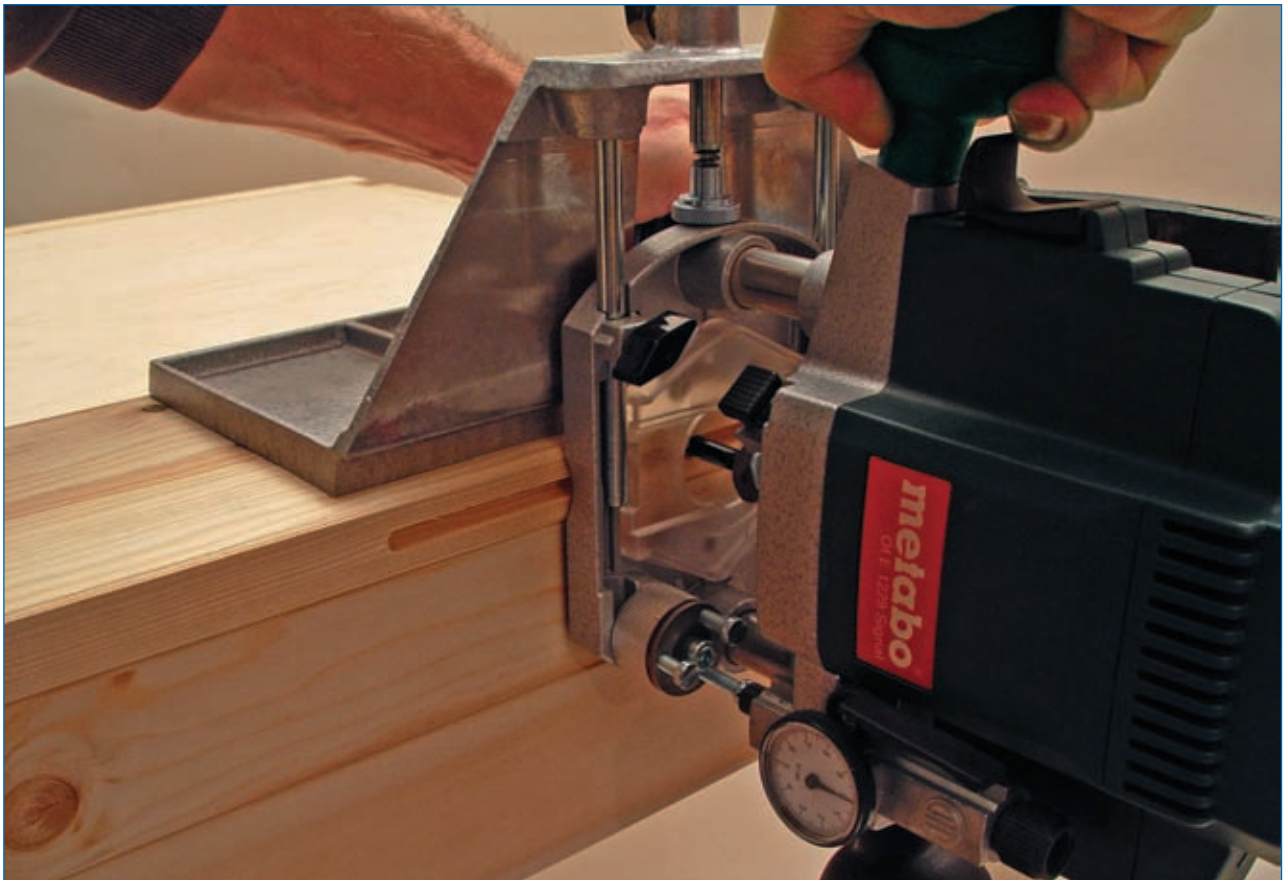
Abb. 4.1.14: Mithilfe eines Winkelanschlags kann man sicher geführt in die Werkstückkante fräsen.
