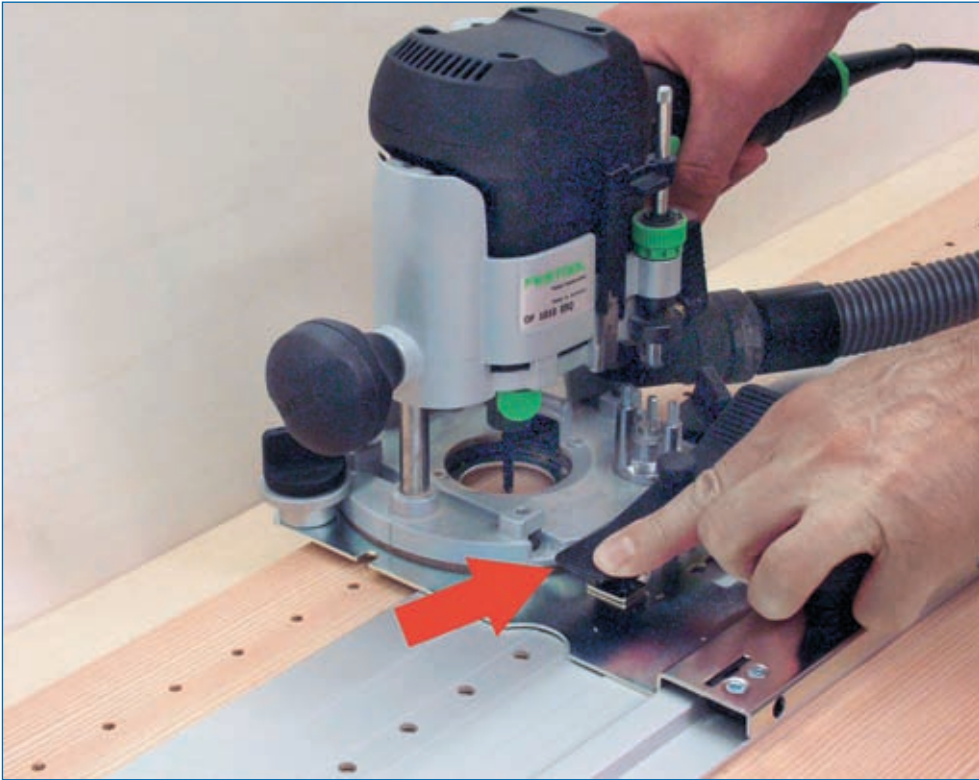
Abb. 4.1.8: Mithilfe einer Führungsschiene und dem dazugehörigen Lochreihen-Set kann man komfortabel Lochreihen in genormtem Abstand bohren ... Quelle [3]
