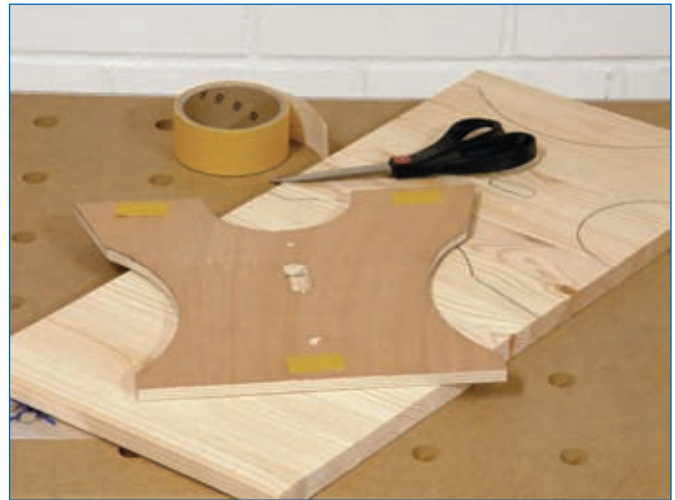
Abb. 4.1.10: Doppelseitiges Klebeband genügt zum Fixieren der Schablone auf dem Werkstück. Quelle [3]
