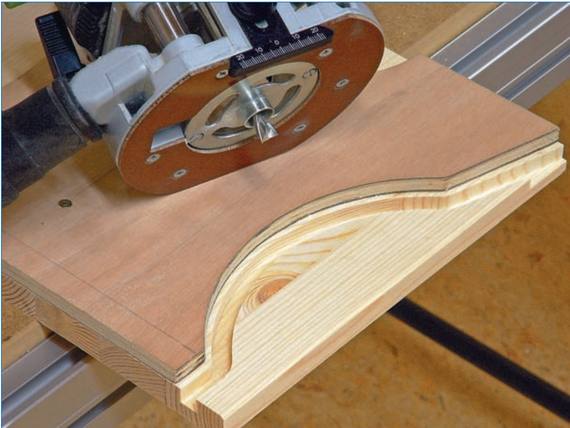
Abb. 1.1.5: Mithilfe einer vorgefertigten Schablone aus Sperrholz wird eine geschwungene Kante gefräst. Quelle [3]
