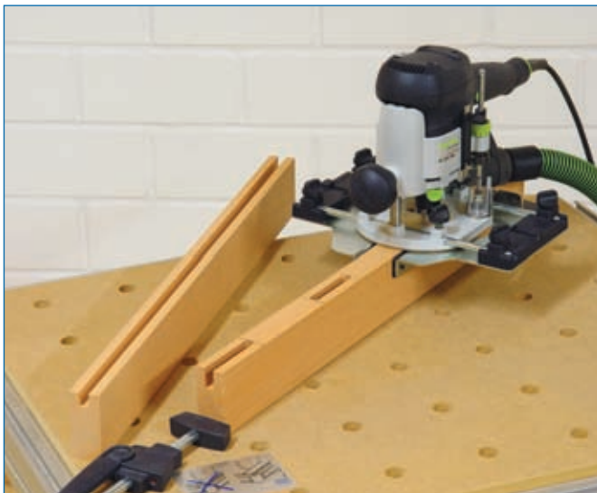
Abb. 4.1.3: Eine selbst angefertigte Holzleiste wird – hier beim Fräsen einer Nut – als Führungsfläche an den Anschlag geschraubt. So kann die Oberfräse sicher über das Ende des Werkstücks hinausgeführt werden.
