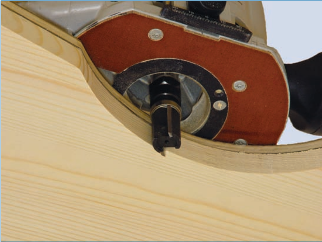
Abb. 4.1.12: Hier befindet sich das Kugellager oberhalb des Fräsers, also arbeitet man mit der Schablone auf dem Werkstück. Quelle [3]
