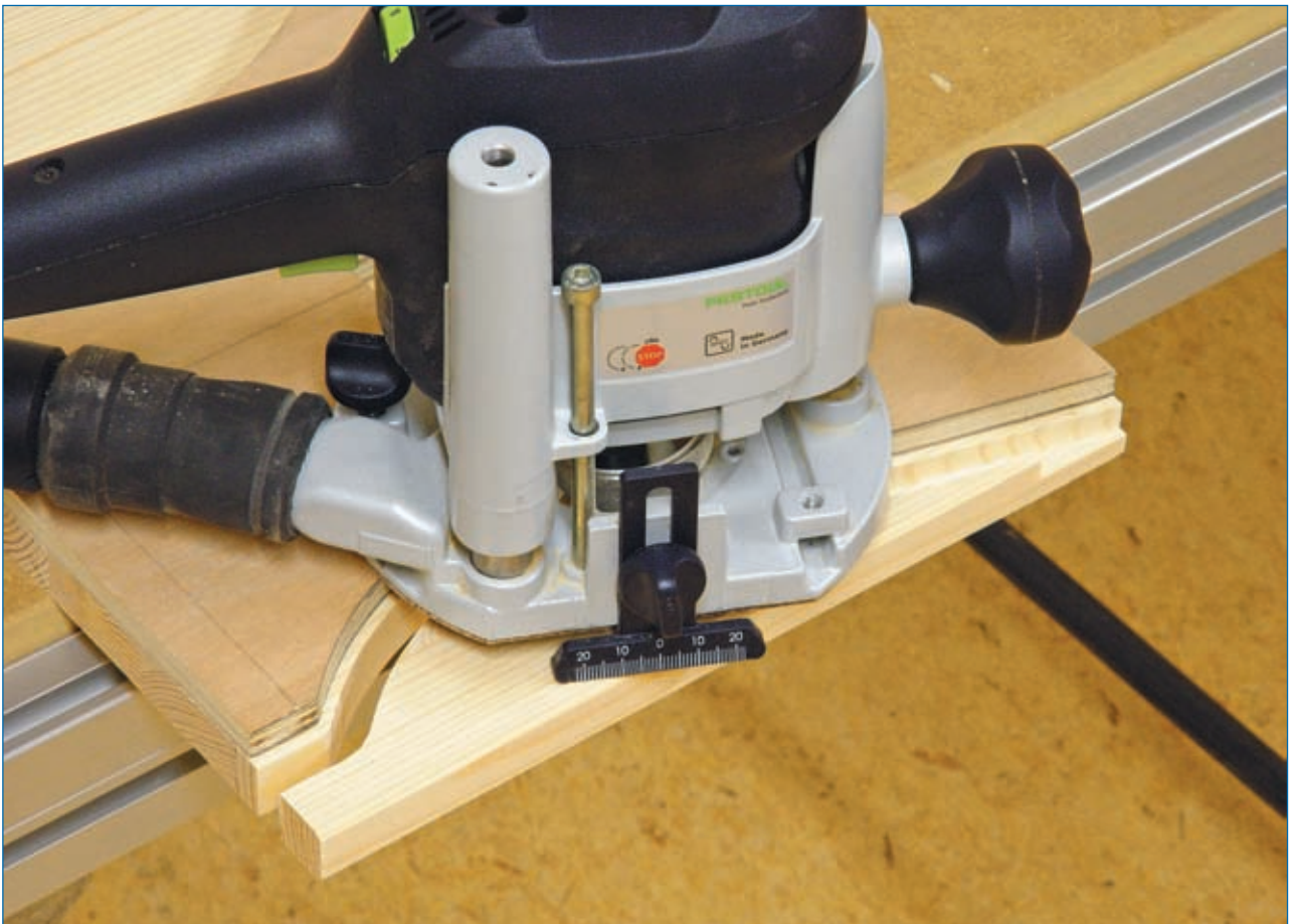
Abb. 4.1.11: Mithilfe von Schablone und Kopierhülse kann man die Oberfräse sicher in der gewünschten Bahn führen, was für eine saubere Fräsarbeit unerlässlich ist. Bei dieser Oberfräse kann man mithilfe der Niveaueinstellungsvorrichtung (Pfeil) vermeiden, dass die Oberfräse kippt. Quelle [3]
