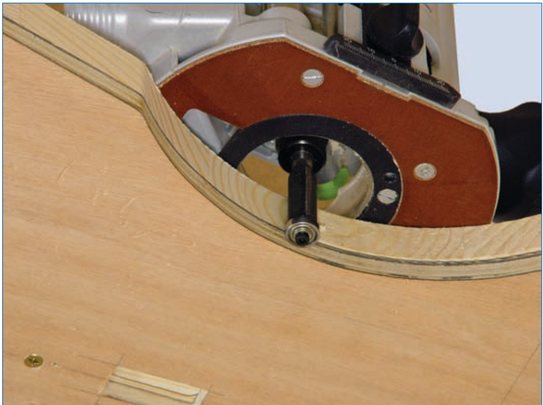
Abb. 4.1.13: Bei einem Fräser mit Kugellager unterhalb der Schneiden befindet sich die Schablone unterhalb des Werkstücks. Quelle [3]
