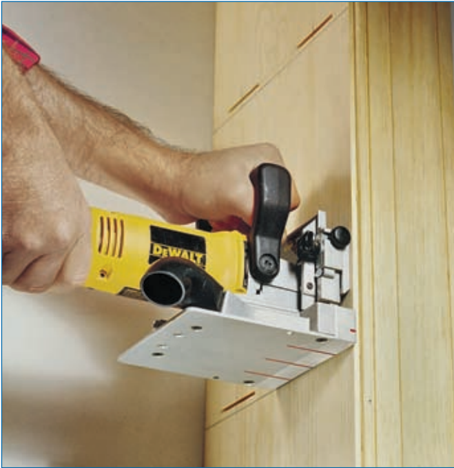
Abb. 1.1.7: Eine spezielle Flachdübel- oder auch Lamellendübelfräse, hier aus dem Hause DeWalt, spart viel Zeit, wenn man Holzverbindungen bevorzugt mit Flachdübeln herstellen möchte. Quelle [2]
