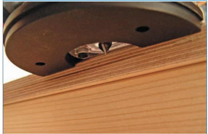
Abb. 4.1.6: Das Distanzstück kann man unter die Fußplatte schrauben und so in festgelegtem Abstand in die Werkstückkante fräsen.
