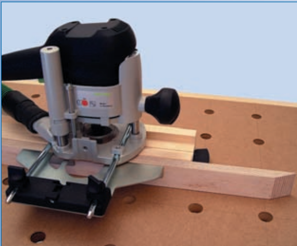
Abb. 4.1.3: Eine selbst angefertigte Holzleiste wird – hier beim Fräsen einer Nut – als Führungsfläche an den Anschlag geschraubt. So kann die Oberfräse sicher über das Ende des Werkstücks hinausgeführt werden.
