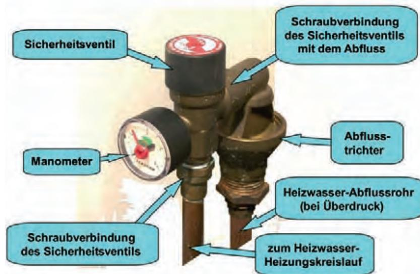
Abb. 59: Ausführungsbeispiel eines Sicherheitsventils, das mit einem Manometer kombiniert ist
