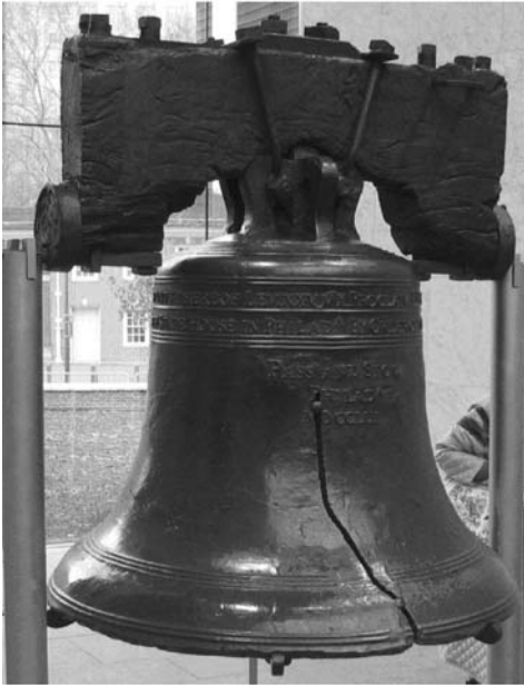
Bild 2.2: Makroskopischer Sprödbbruch der Liberty-Glocke, Philadelphia 1752
