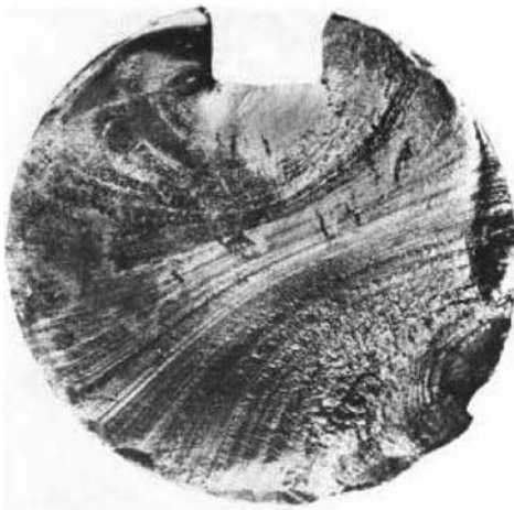
Bild 2.4: Schadensfall durch Ermüdungsbruch an einer Welle
