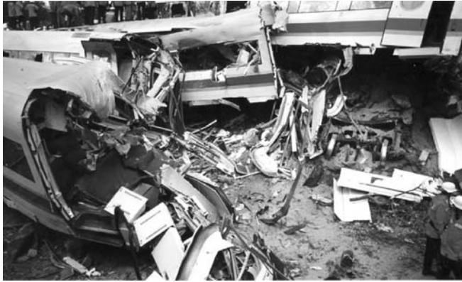
Bild 1.3: ICE Eisenbahnunglück bei Eschede 1998 als Folge eines gebrochenen Radreifens
