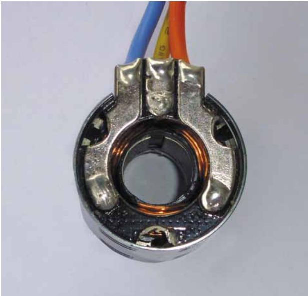
Abb. 2.10 – Im Stator dieses Außenläufers sind drei Wicklungen zu erkennen.
