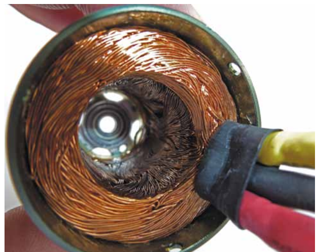
Abb. 2.12 – Statorwicklungen eines Brushless-Innenläufers
