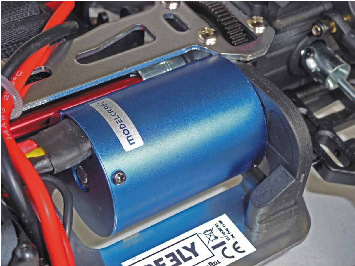
Abb. 2.7 – Brushless-Innenläufer stellen heute die überwiegende Antriebsart elektrisch betriebener RC-Cars dar.
