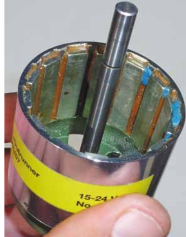
Abb. 2.14 – An der Innenseite der sich drehenden Motorglocke des Außenläufers sind die Dauermagnete angeklebt. Die Rotoren der Innenläufer gewähren auf sie keinen Blick.
