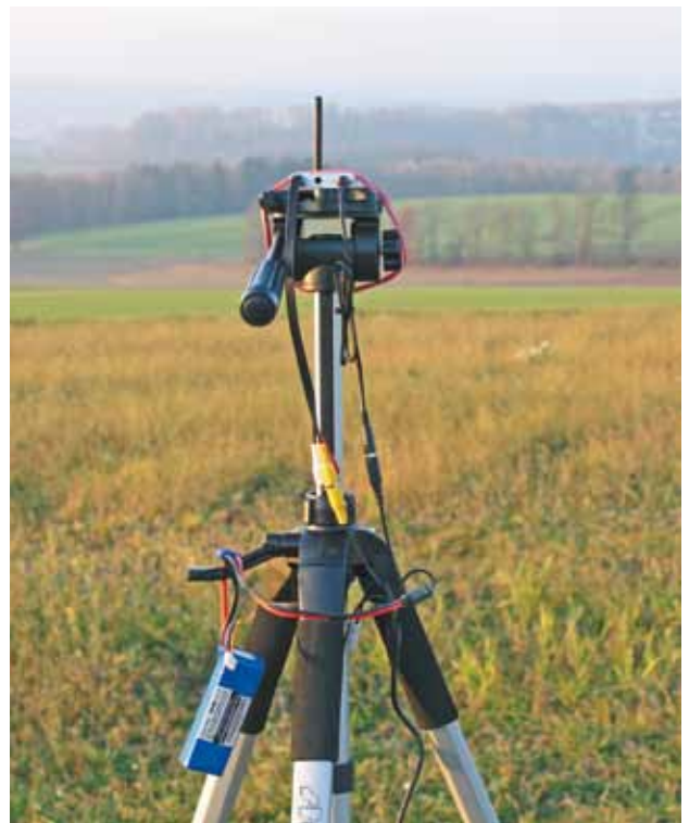
Der Empfänger wird oben am Stativ befestigt. Für Versuche lässt er sich auch mit einem einfachen Gummiring fixieren.
