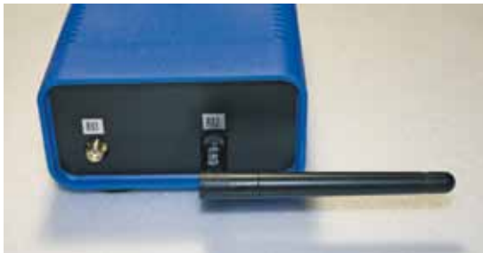
Diese Antenne wurde horizontal polarisiert am Empfänger angebracht.
