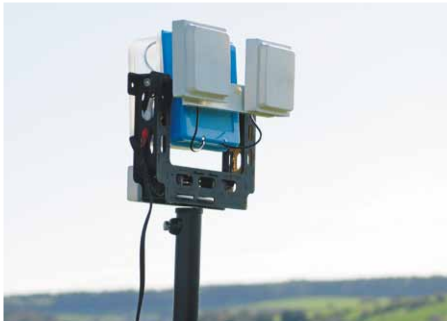
Eagle-Tree-System bestehend aus Komponenten für das Flugzeug, der Mechanik für die Antennennachführung und der Auswerteeinheit für die Bodenstation. (Bild: Globe-Flight)
