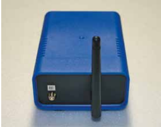
Diese Antenne wurde vertikal polarisiert am Empfänger angebracht.
