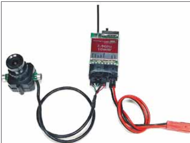
Manche Hersteller bieten auch fertig konfektionierte Kamera-Sender-Lösungen an. Für die Leser mit wenig oder gar keiner Erfahrung beim Löten ist das die beste Möglichkeit, in das Hobby FPV einzusteigen. (Bild: Globe-Flight)
