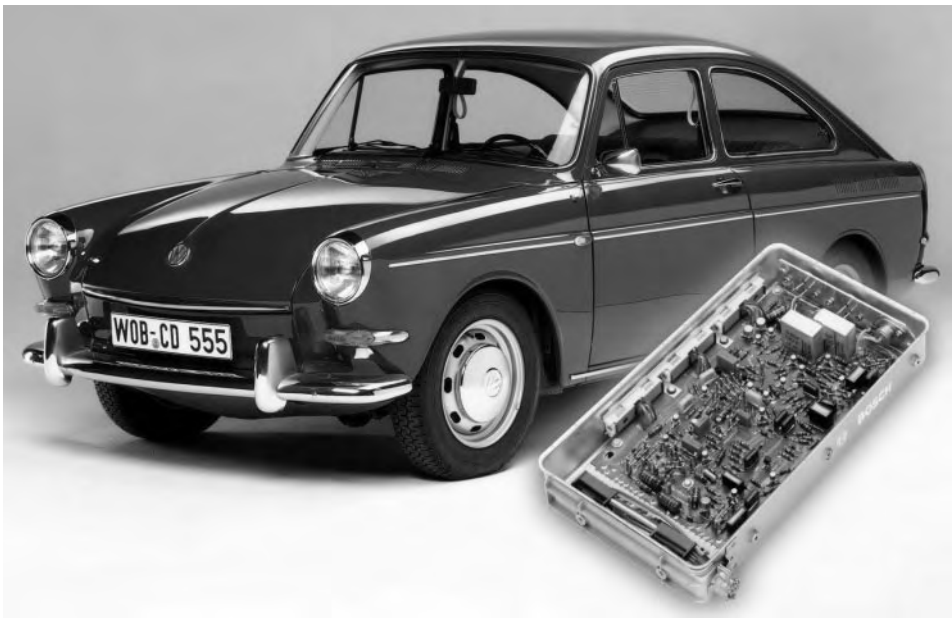
Bild 1.3: Volkswagen 1600 LE/TLE von 1967 mit Bosch-D-Jetronic-Steuergerät für das elektronisch gesteuerte Benzin-Einspritzsystem (Foto: Bosch)
