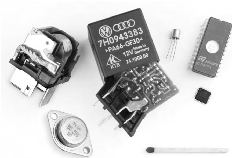
Bild 1.5: Typisches Kfz-Lastrelais, Leistungstransistor, Kfz-Relaisstecker, in dem sich nur Elektronik und gar kein Relais mehr befindet, Kleinsignaltransistor, EPROM mit Löschenfenster, moderner Mikrocontroller
