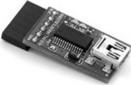
Bild 3.8: USB-Adapter mit FTDI-Chip (Quelle: Elmicro)
