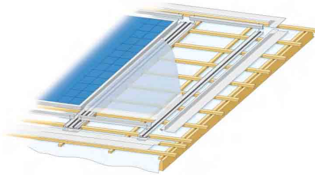
Abb. 4.20: Bei der Indachmontage schraubt man einen Metallrahmen auf die Dachleisten, in die sich die Solarmodule einsetzen lassen. (Foto: Schüco)
