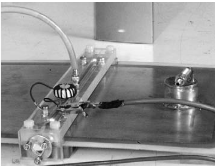
Abb. 5.9: Der Betrieb des TEA-Lasers mit Luft
