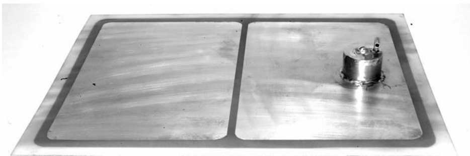
Abb. 5.5: Die fertige Bandleitung mit aufgelöteter Funkenstrecke
