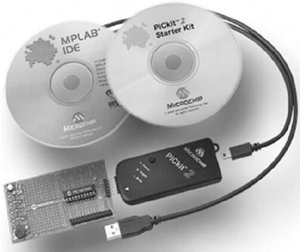
Dieses Kit gibt es mit der kompletten Dokumentation: Beschreibungen, PC-Software, PIC-Firmware als Quellcode und Schaltplan. Damit soll der Benutzer in die Lage versetzt werden, sein eigenes USB-Gerät zu realisieren.
