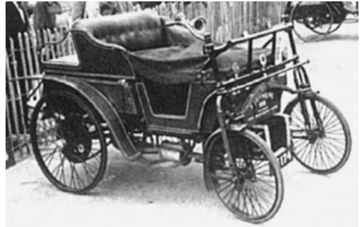
**Bild 1-12:** Vertikalvorderradführung von Stephens 1898
