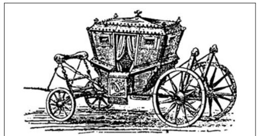
**Bild 1-5:** Pferdekutsche mit Aufhängung, Federung, Bremse und Lenkung
