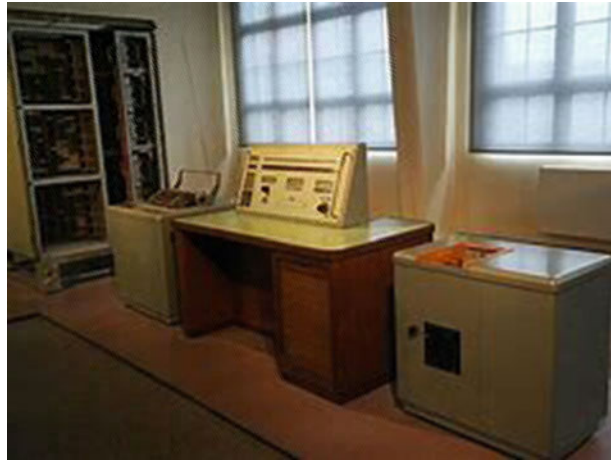
Abb. 1.1 Der Zeiss-Rechenautomat ZRA 1
