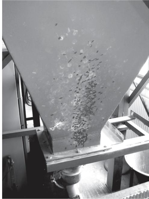
Abbildung 1.2 zeigt eine Reihe von Problemen, die beim Betrieb von Silos auftreten können. Ist die Auslauföffnung zu klein, kann sich ein stabiles Gewölbe (Brücke) bilden, so dass der Schüttgutfluss zum Erliegen kommt (Abb. 1.2a). Sind die Partikel groß im Verhältnis zur Auslauföffnung, liegt dies am Verkeilen der Partikel. Bei feinen Schüttgütern ist die Ursache die Festigkeit des Schüttgutes aufgrund von Haftkräften zwischen den Partikeln.
