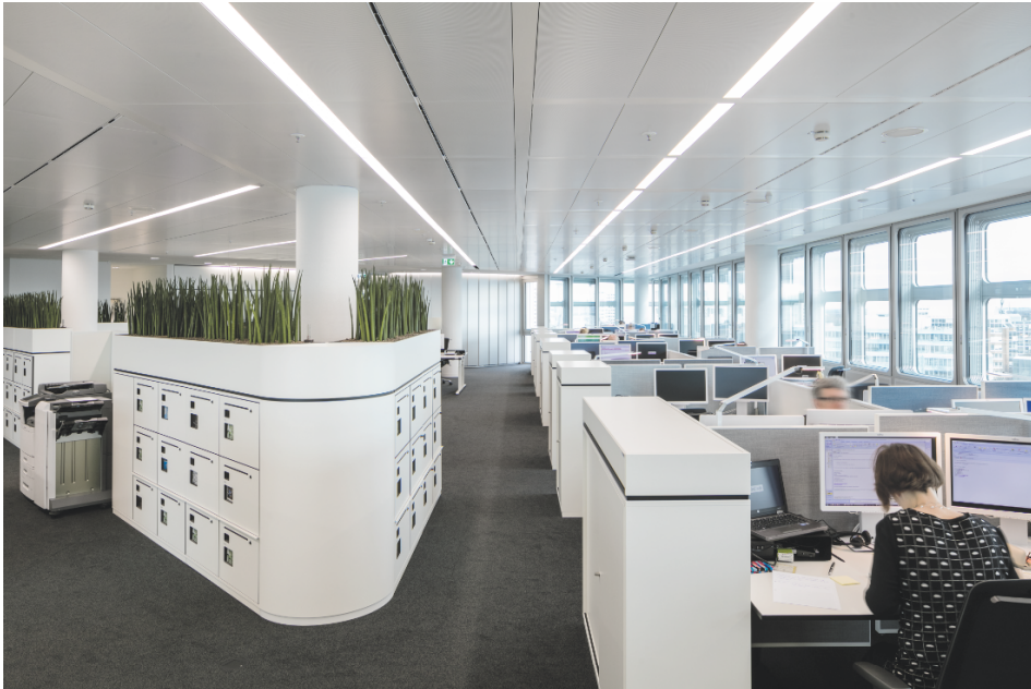
Bild 2-6 Büroraum (Focus-Area) mit Heiz-/und Kühldecken und einer Kastenfensterkonstruktion zur natürlichen Belüftung (Foto: ©HGEsch).
