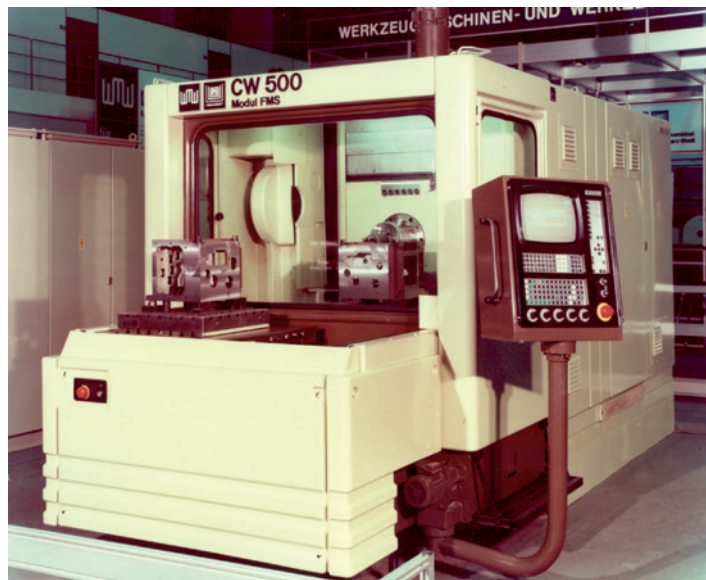
Bild 1.1: Die vom DDR-Steuerungshersteller VEB NUMERIK produzierte CNC-600 im Einsatz an einer Heckert-Maschine CW500, die auch als Modul für den Einsatz in flexiblen Fertigungssystemen (FMS) genutzt wurde.
