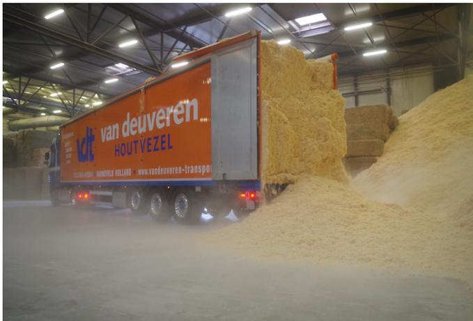
**Abb. 2.2** Lawineneffekt und Sägemehlstaub nach Schubboden-Transport (Knapen Trailers, 2019)
