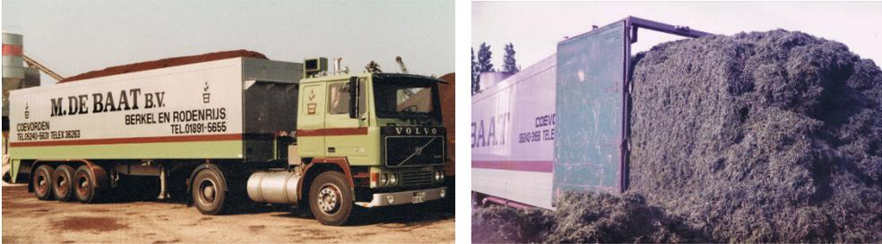
**Abb. 1.2 a)** Schubboden-Trailer bei DeBaat BV      **b)** Abladung von Torf
