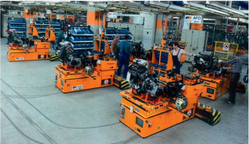
**Bild 1-7** Triebsatzvormontage bei VW in Hannover (Quelle: DS, 1986)
