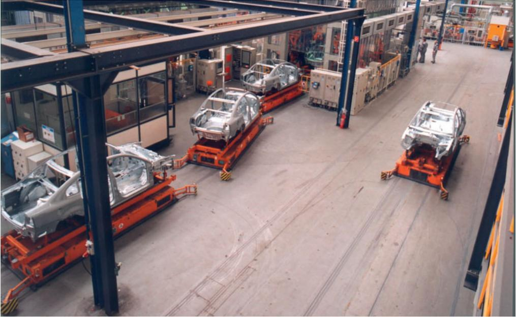
**Bild 1-6** PKW-Herstellung mit FTS: Fahrzeugbau des VW Passat bei VW in Emden (Quelle: DS, 1986)
